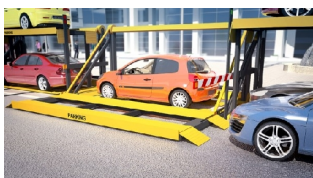
استقرار طبقه دوم روی سطح زمین برای بارگیری خودرو
