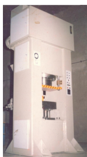
پرس هیدرولیک تولید آجر نسوز
