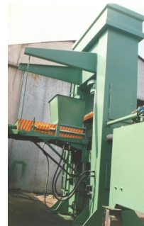
پرس هیدرولیک تولید آجر نسوز
