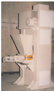
پرس هیدرولیک تولید آجر نسوز
