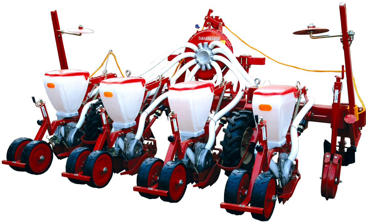
شکل ۲۴- ردیفکار پنوماتیک مخصوص کاشت دو ردیف ذرت روی یک پشته
