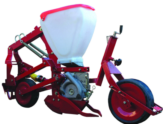
شکل ۲۳- یونیت کارنده مخصوص بذرهای ریز
