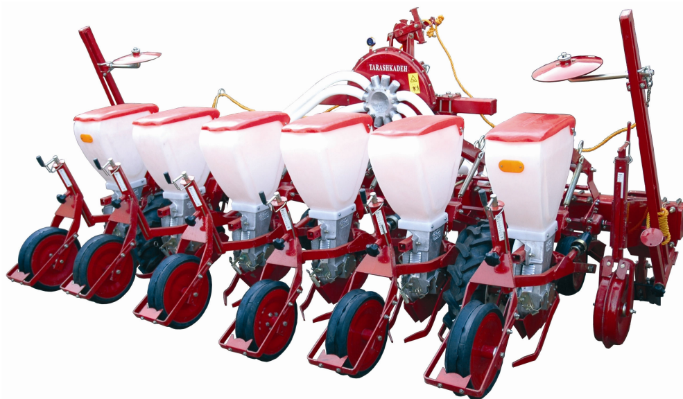
شکل ۲۱- ردیفکار پنوماتیک مخصوص کاشت بذرهای ریز
